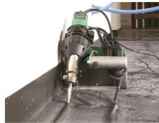
**La distancia mínima de la pared de sólo 51 mm** permite una fácil soldadura de las gargantas uniones más comunes e incluso verticales. La baja altura de la unidad permite la soldadura continua ya que el paso es de al menos 295 mm de altura.
